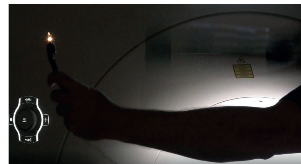
Abb. 2: Im MRT erfolgt eine Induktion von Strömen auch ohne eine eingeschaltete Stromversorgung
