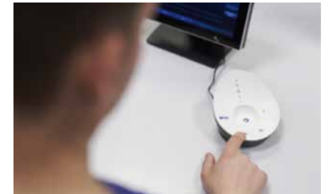
Abb. 4 Gespiegelte LED-Anzeigen auf Ladeschale und Patienteneinheit zeigen synchron an, ob die Saugintensität des Müller-Manövers passt
