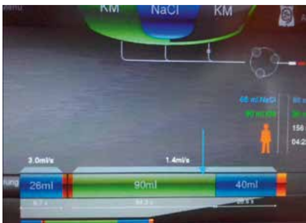
Abb. 6: Protokollbeispiel Kontrastmittelinjektor Start der Akquisition genau nach 60 Sekunden (blauer Pfeil)
